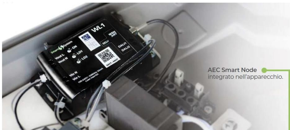
Figura 20 – Dettaglio dell'AEC Smart Node installato a bordo lampada.
